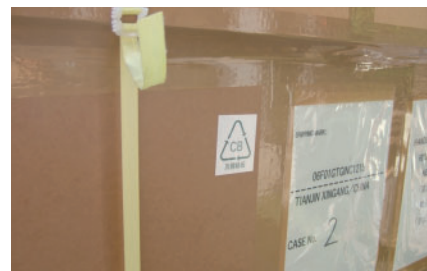
自動改札機の梱包状態 (中央三角形が汚染防止ラベル)
