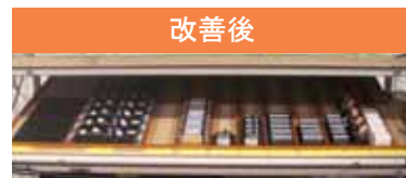
スライド方式で常に部品が手前になるように改良
