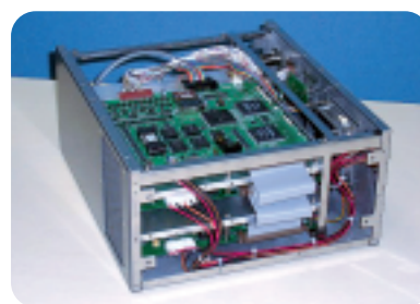
最上段の基板が制御基板
